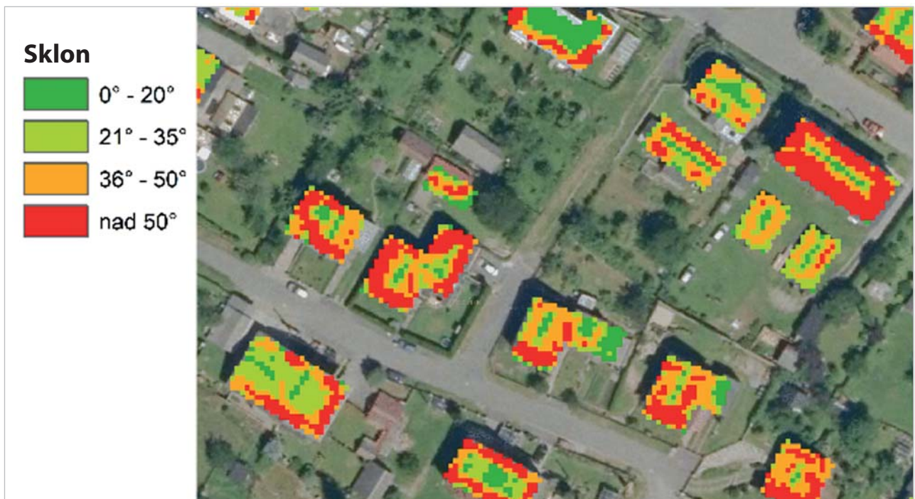
Obr. 4 Klasifikace sklonu střech budov
