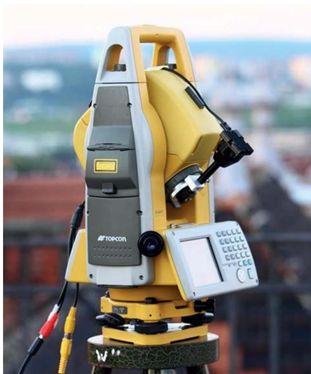
Obr. 1 Detail upevnění kamery na přístroj Topcon GPT 9001A
