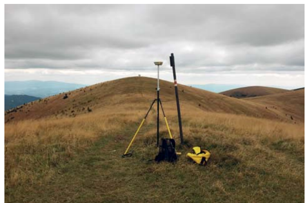
Obr. 2 Prijímač globálneho navigačného satelitného systému na trigonometrickom bode Ostredok, v pozadí vyšší vrchol
