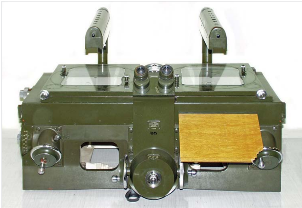
Obr. 1 Fotogrammetrický přístroj pro vyhodnocování snímků Stecometr 1818 firmy Zeiss-Jena (foto: Dr. Ing. Karel Pavelka, FSv ČVUT v Praze)
