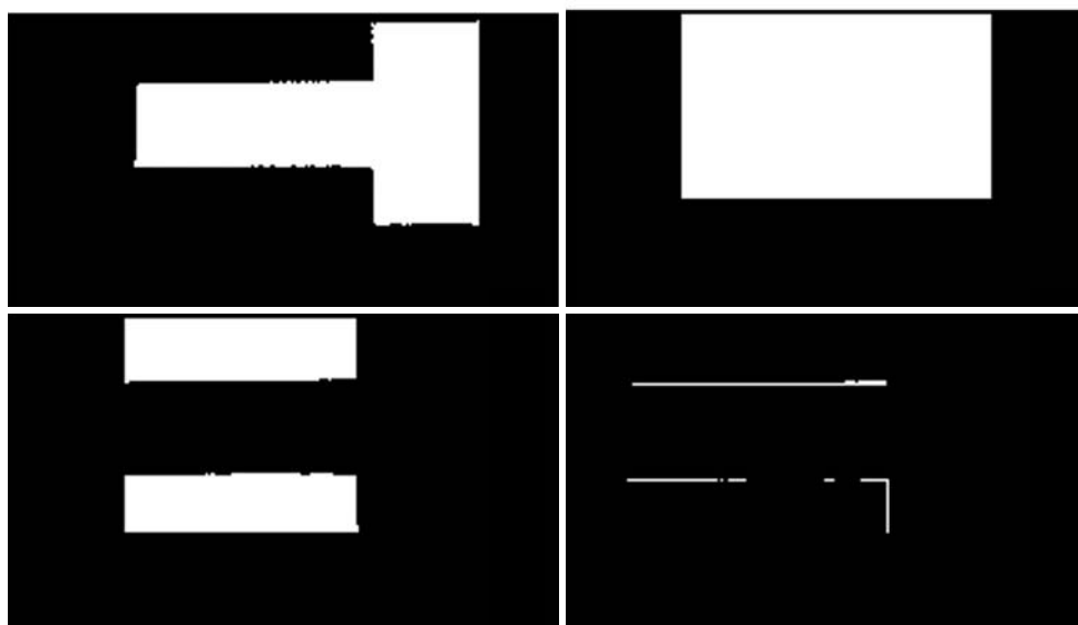
Obr. 4 Rotovaná budova (vľavo hore), MBR (vpravo hore), rotovaná budova - MBR (vľavo dole), nové malé regióny (vpravo dole)
