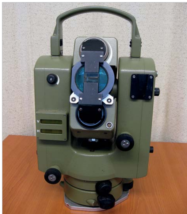
Obr. 8 E2 s DM503A předsádkou pro průmyslový hranol, FSv ČVUT – K 1154 (foto autoři)
