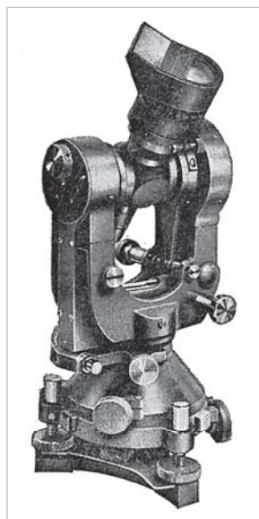
Teodolit s hranolovým nástavcom (hladač poludníka)
