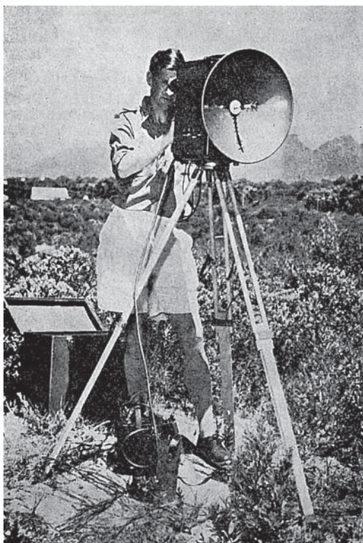
Telurometer - prístroj na meranie dĺžok
