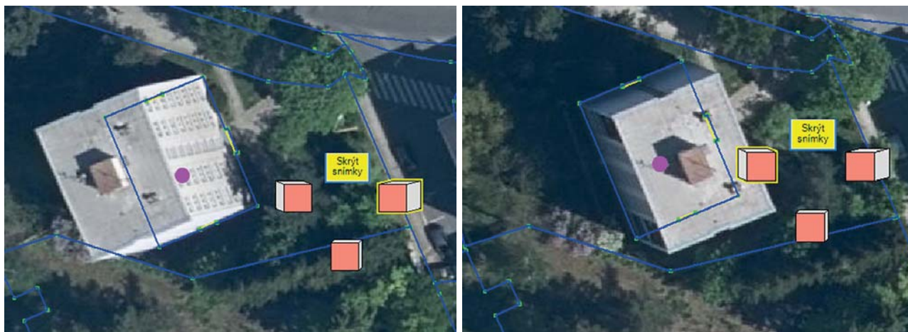
Obr. 5 Jednotlivé ortogonalizované snímky s tlačítky pro zobrazování paty budovy z různých stran
