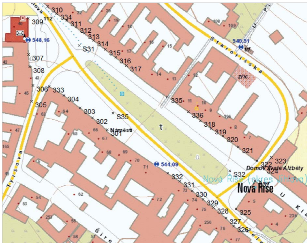
Obr. 11 Geodetické zaměření kontrolních bodů (rohů budov v úrovni terénu)
