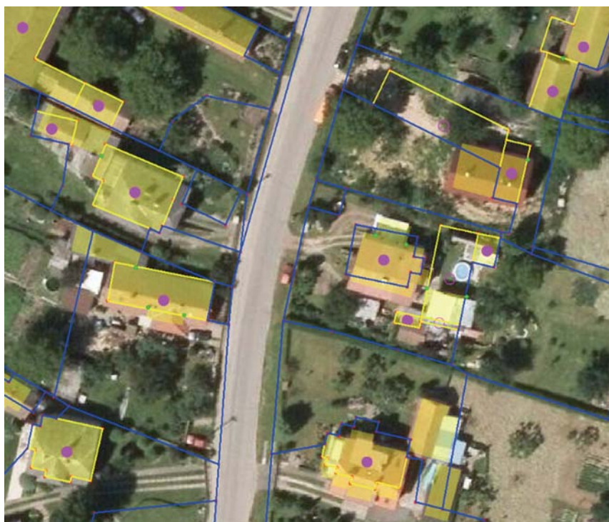
Obr. 4 Obsah katastrální mapy (modrý) v kompozici s Ortofotem ČR; nové budovy jsou vyznačeny polygony se žlutou výplní
