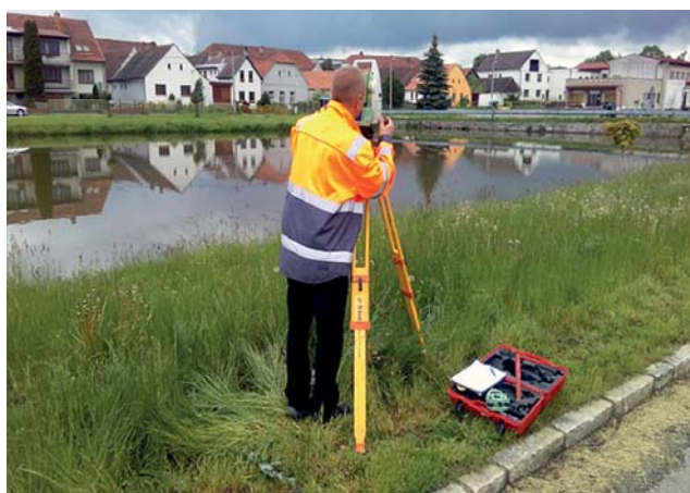
Obr. 8 Geodetické zaměření stanovišek a kontrolních bodů; měřický náčrt
