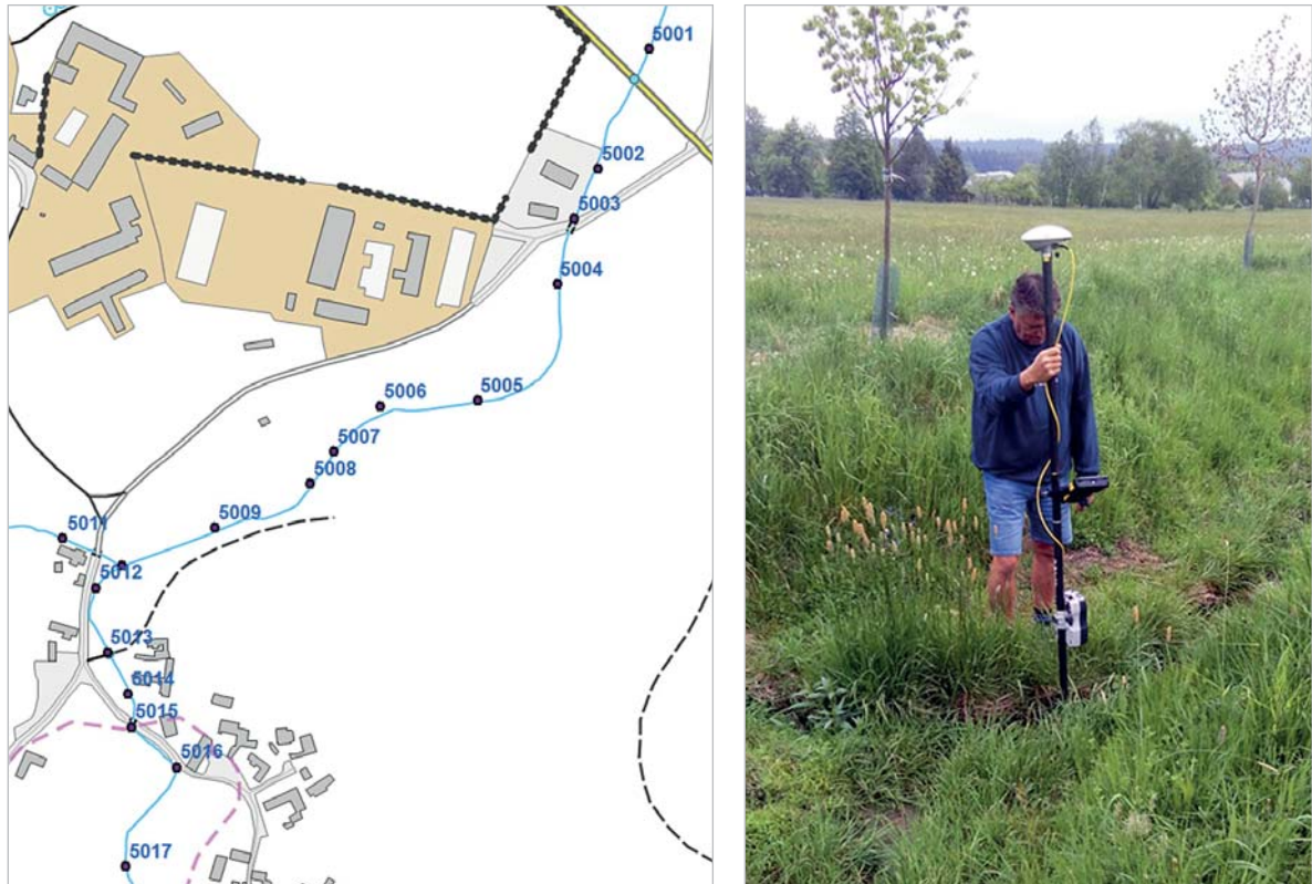
Obr. 9 Geodetické zaměření osy vodního toku mobilní aparaturou GNSS
