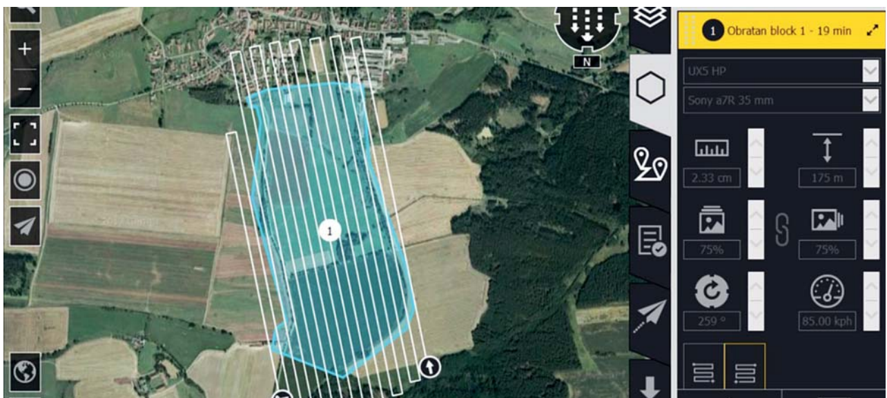
Obr. 3 Plánování letu, letových drah a překrytí snímků systémem Trimble
