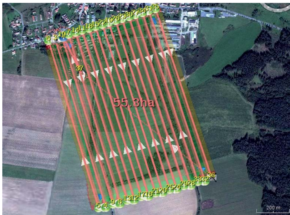
Obr. 4 Plánování letu, letových drah a překrytů snímků systémem MAVinci
