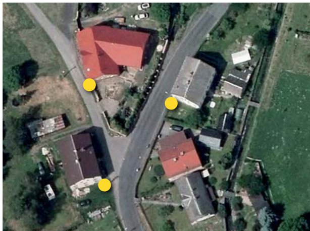
Obr. 4a Identifikace kontrolních bodů (rohů domu) na Ortofotu ČR
