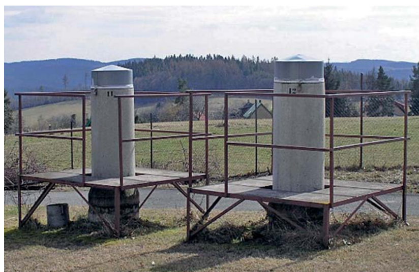
Body testovací základny pro aparatury recentních pohybů zemské kůry (ICRCM) GNSS v areálu GO Skalka
