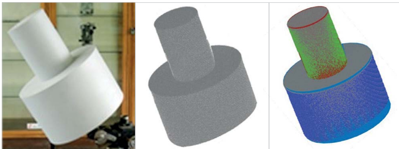
Obr. 2 Referenčné teleso valcového tvaru (vľavo), merané mračno bodov (v strede), výsledok segmentácie valcov pomocou navrhnutého algoritmu (vpravo)
