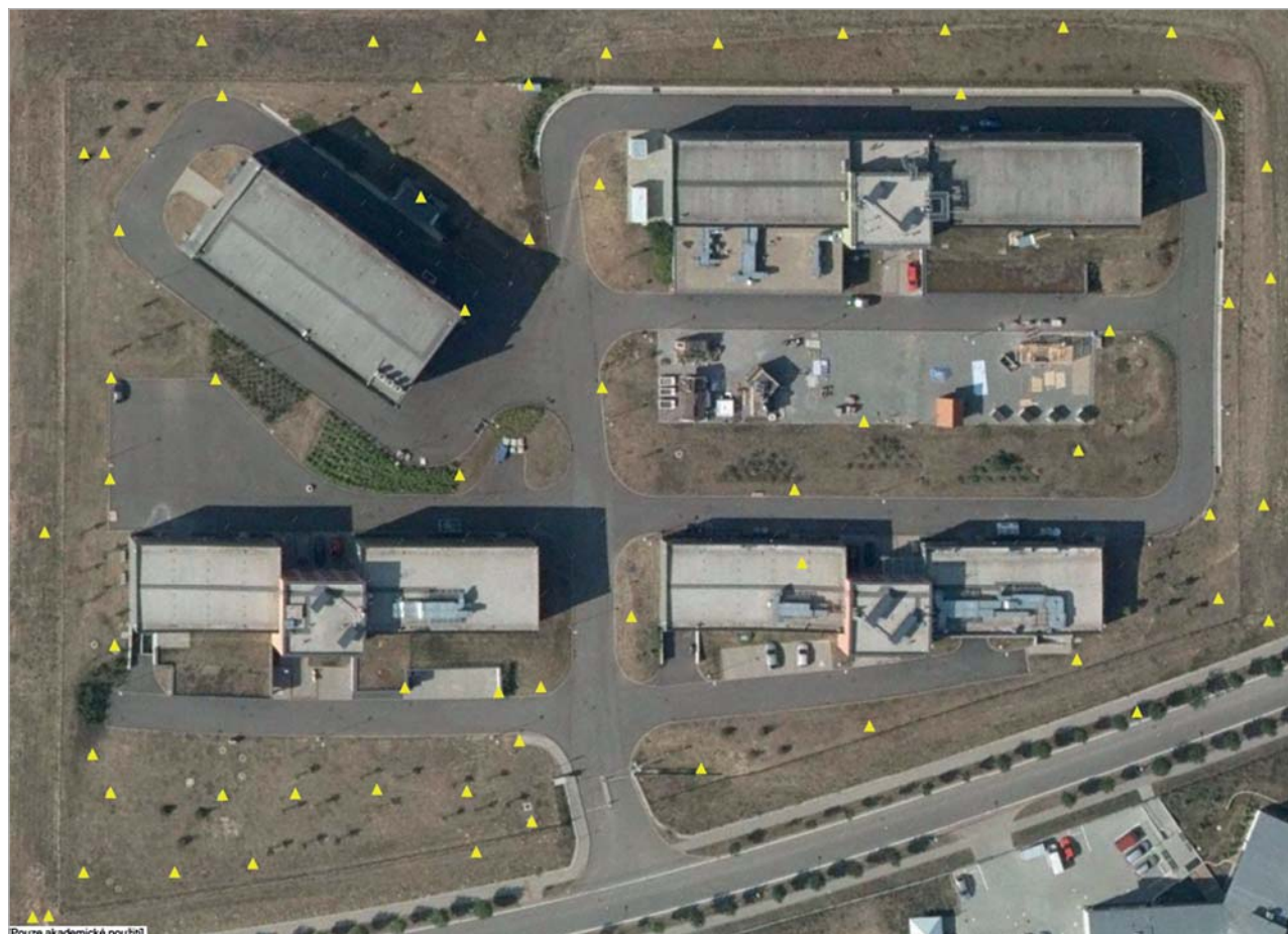
Obr. 1 Rozložení signalizovaných bodů v lokalitě AdMaS
