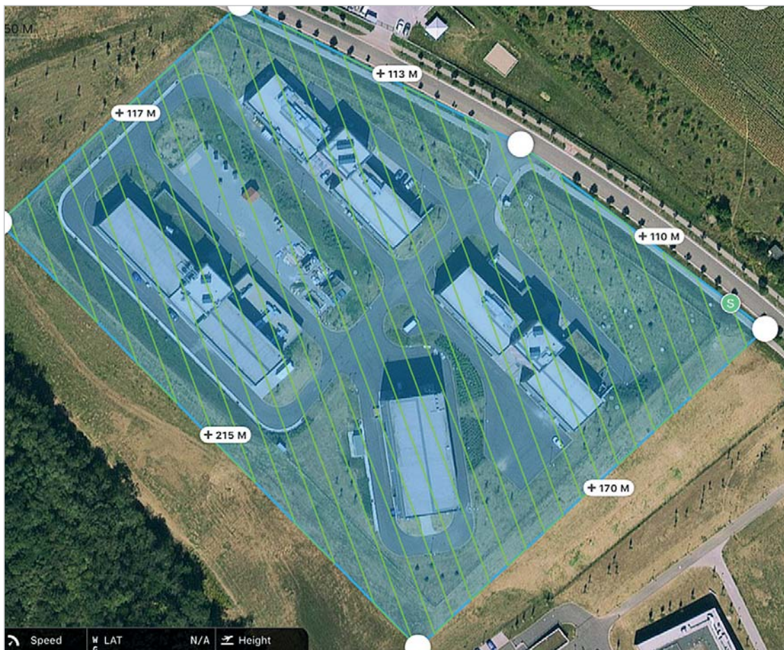
Obr. 2 Letové řady pro GSD 1 cm
