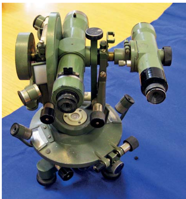
Obr. 10 Buzolní teodolit VEB FPM (bez busoly), VUT FAST v Brně (foto P. Hánek)
