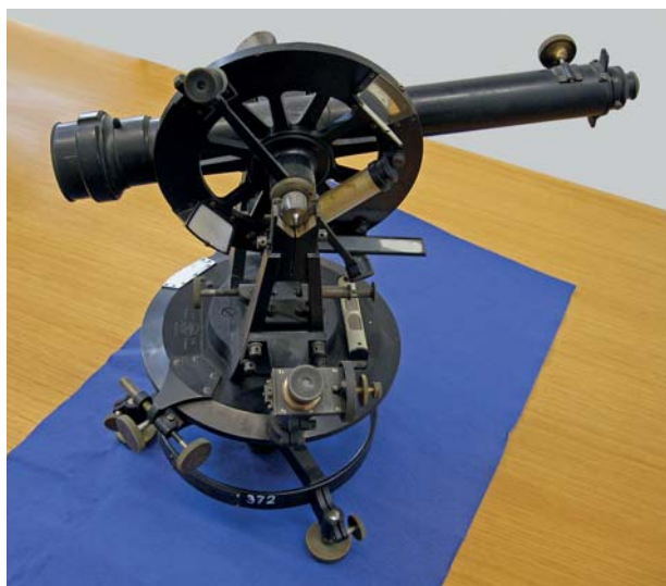
Obr. 2 Teodolit Hildebrand früher August Lingke, VUT FAST v Brně (foto P. Hánek)
