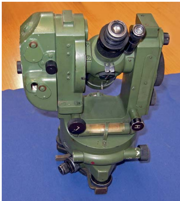
Obr. 9 Teodolit VEB FPM Theo 2 s osvětlením, VUT FAST v Brně (foto P. Hánek)
