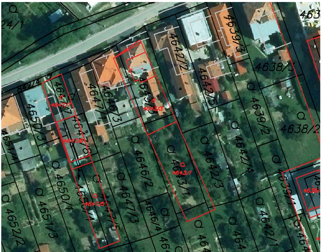
Obr. 1 Príklad hrubej chyby v SPM
