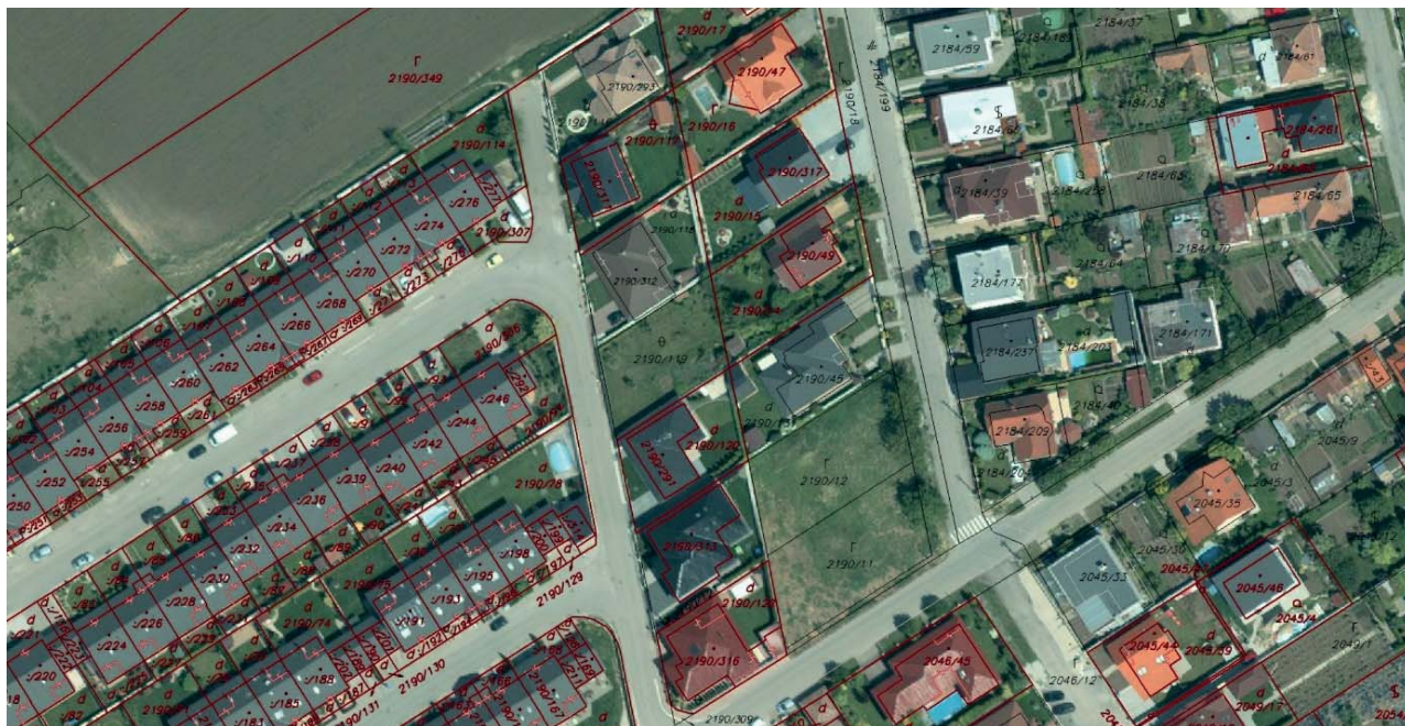
Obr. 10 Ukážka novovzniknutej VKMi (čiernou, sivou farbou) a SPM (červenou farbou)
