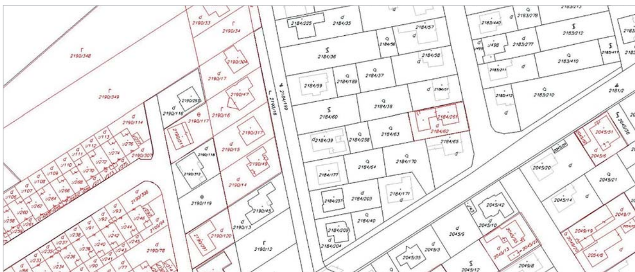
Obr. 9 Ukážka stavu VKMt spresnená s odstránenými objektmi SPM (čiernou, sivou farbou) a doplnenými objektmi zo SPM (červenou farbou)
