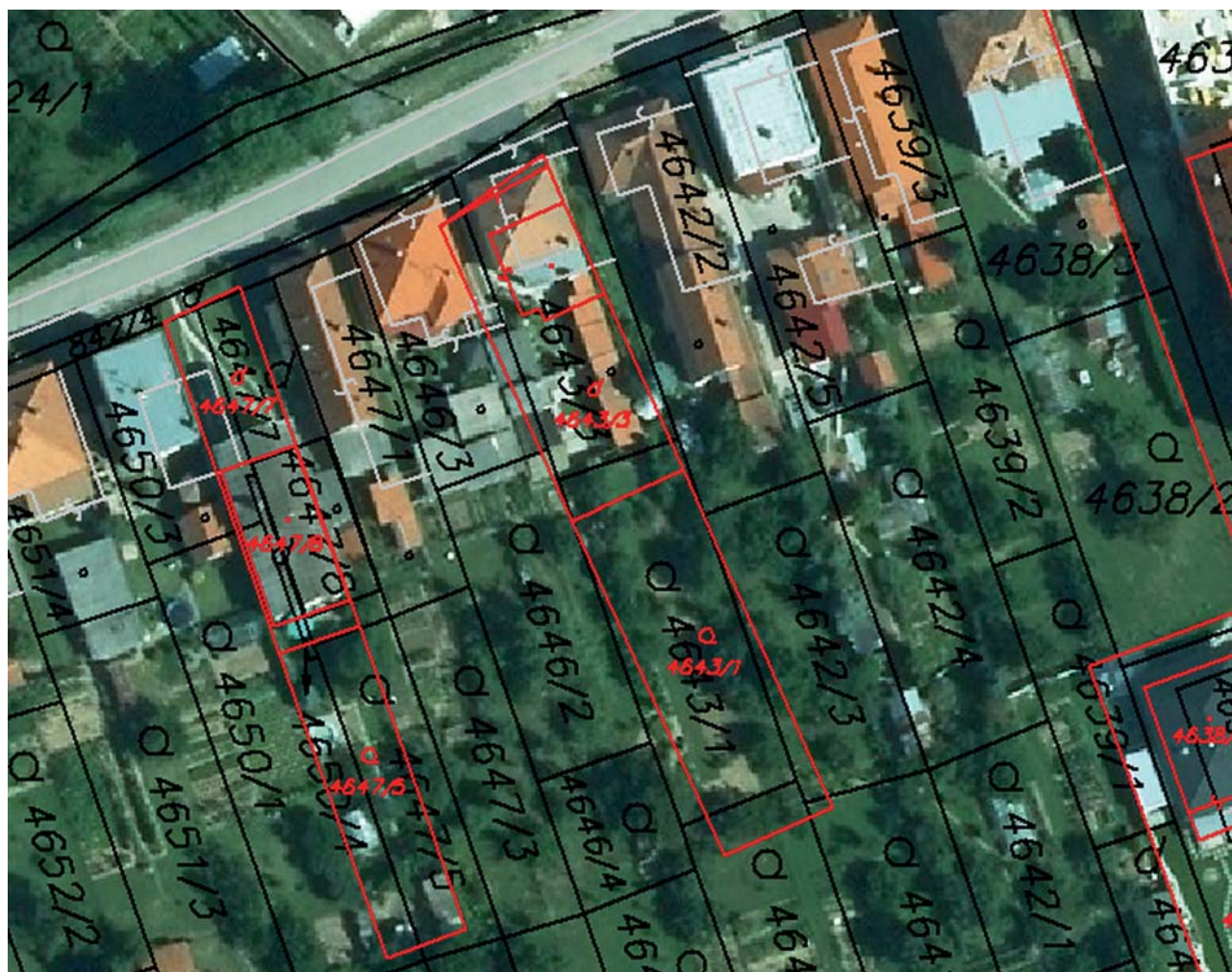
Obr. 1 Príklad hrubej chyby v SPM
