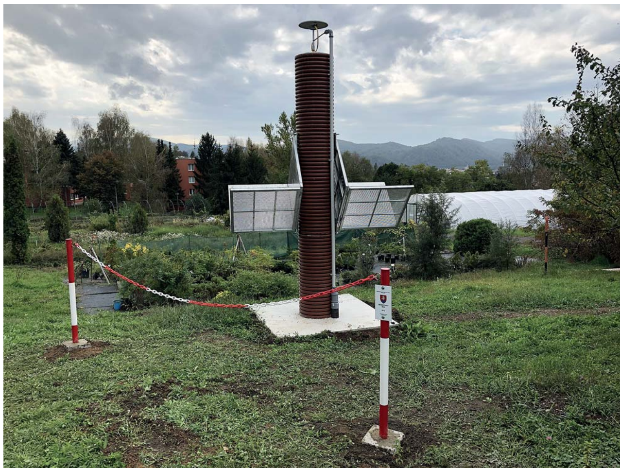
Obr. 2 Ukážka permanentnej kolokačnej stanice ZVOL pre technológie GNSS a InSAR
