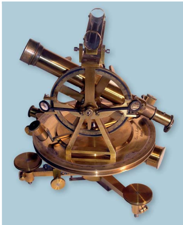
Obr. 6 Teodolit Reichenbach – Ertel, 1821, zdroj: [21]
