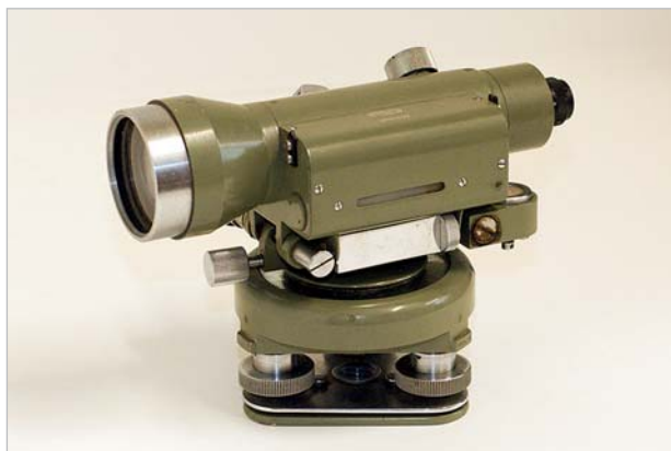
Obr. 9 Nivelační přístroj NK 30 \times (soukromá sbírka, foto: Stanislav Dvořák)
