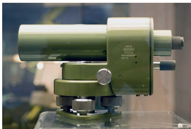
Obr. 10 Nivelační přístroj MNK 20 (Národní technické muzeum, foto: Stanislav Dvořák)
