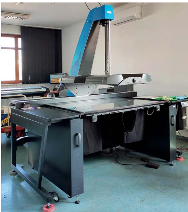
Obr. 12 Nově pořízený velkoformátový skener s možností skenování podkladu ve velikosti A0+ (foto: autor, červen 2022)
