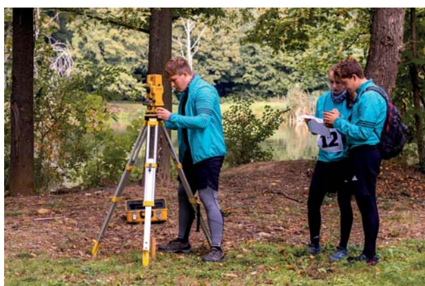
Obr. 4 Horizontace a centrace totální stanice, družstvo Brno B12
