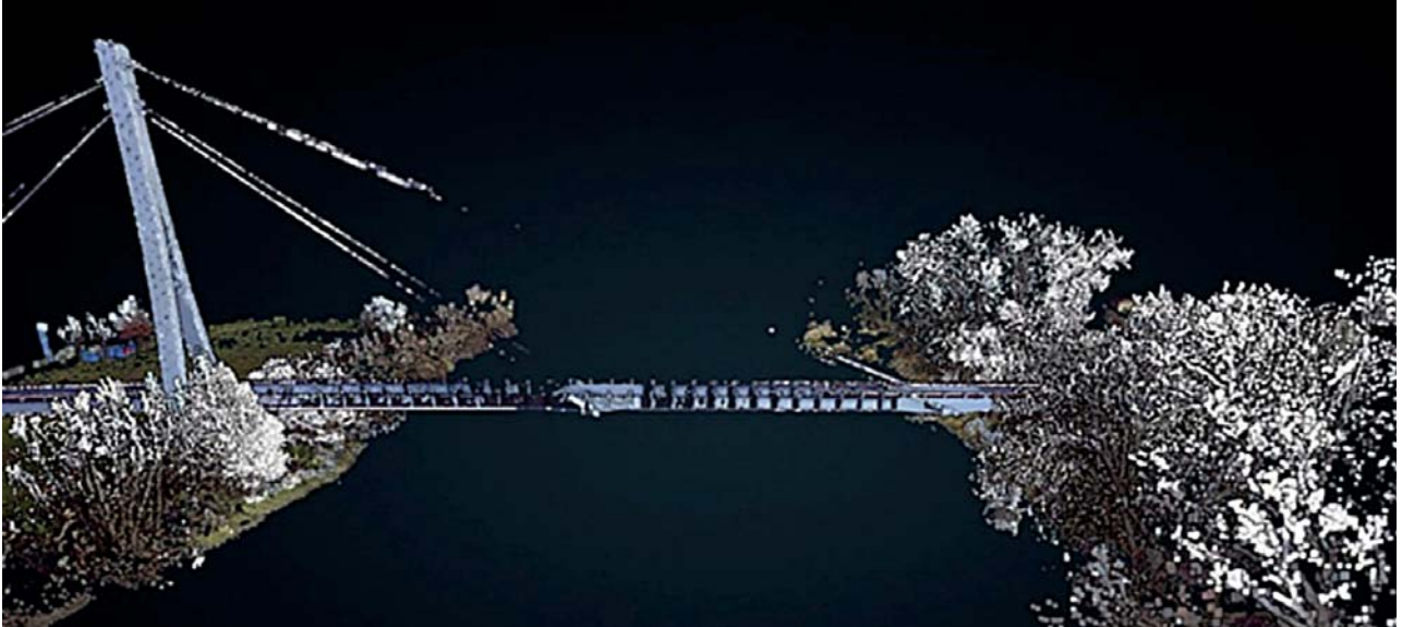
Obr. 4 3D model lávky vytvoření laser skenerem
