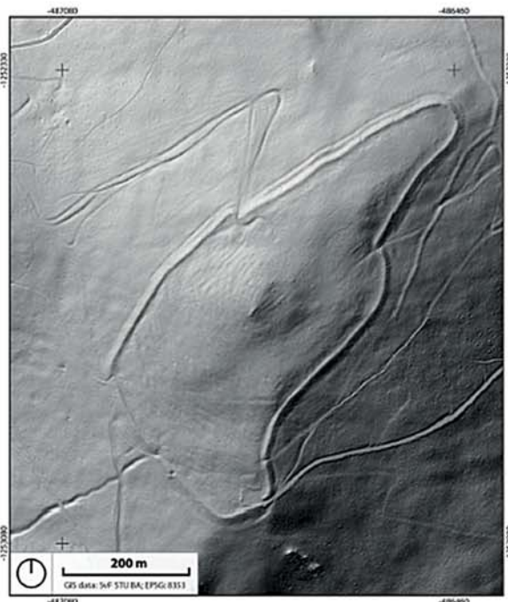
Obr. 7: Digitálny model reliéfu hradiska Tribeč (25 cm/pixel) vizualizovaný pomocou tieňovania (azimut 315°, výška slnka 35°).
