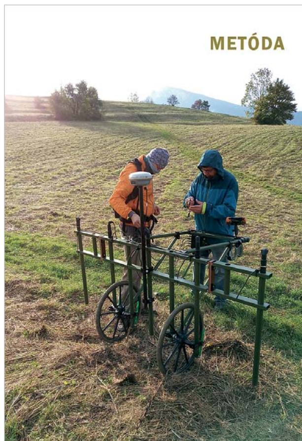
Obr. 2 Obrázok z kapitoly Metóda znázorňujúci meranie magnetometrom
