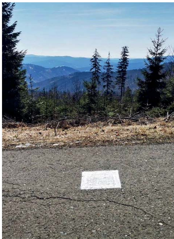
Obr. 3 Zajišťovací bod signalizovaný nátěrem na vozovce
