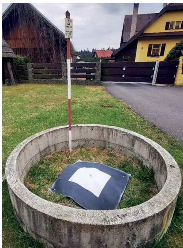
Obr. 2 Trigonometrický bod ve skruži signalizovaný terčem
