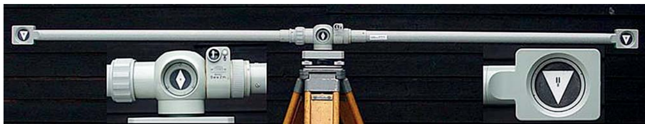
Obr. 9 Základnová lať Zeiss Bala, zdroj: [26]
