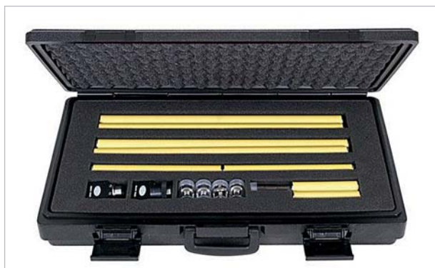
Obr. 11 Invarová měřítková lať, zdroj: www.brunson.us
