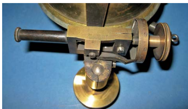
Obr. 10 Detail jemné ustanovky s mikrometrem, foto: autoři
