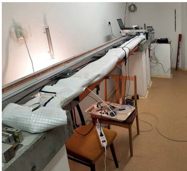
Obr. 7 Pohled do kalibrační laboratoře VÚGTK během určování teplotní roztažnosti, foto: autoři
