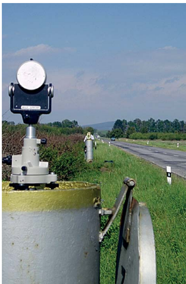
Obr. 4 Národní etalon dlouhých délek (24 až 1 450 m)
