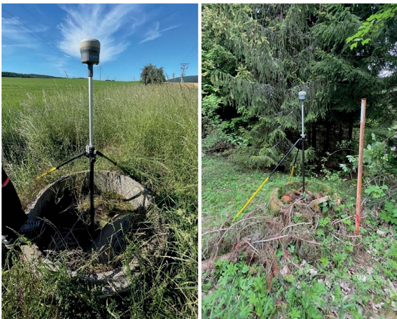
Obr. 3 Ukážka merania v ideálnych (vľavo) a sťažených podmienkach (vpravo)
