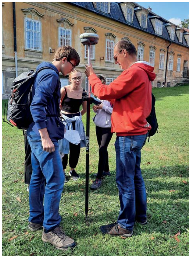
Obr. 2 Nejmodernější měřické techniky s využitím globálních navigačních družicových systémů
