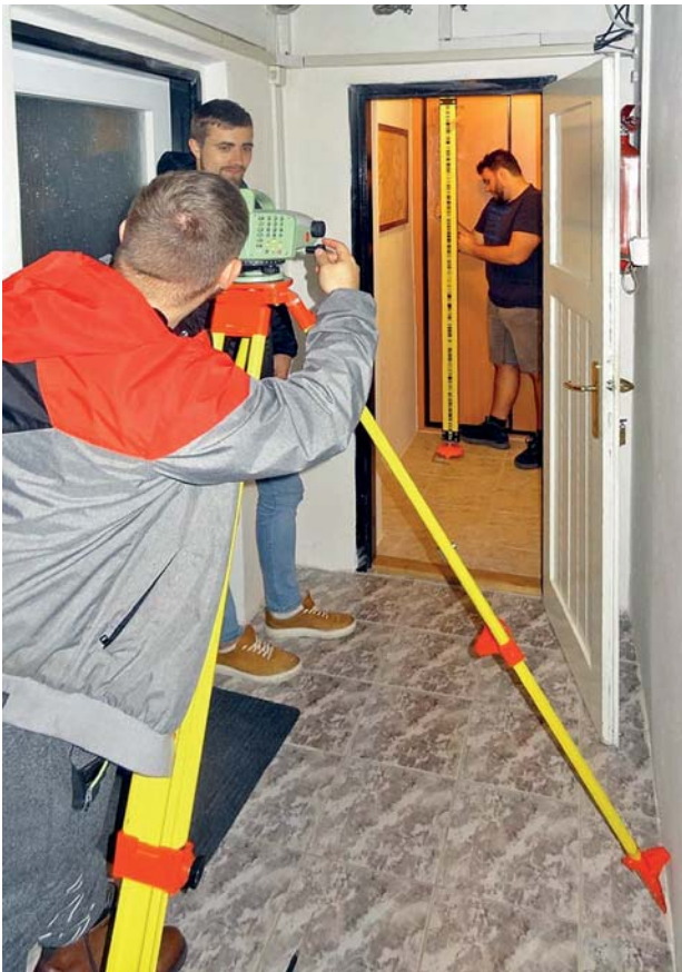
Obr. 3 Nivelační měření absolutního tíhového bodu v hlavní budově observatoře v roce 2023
