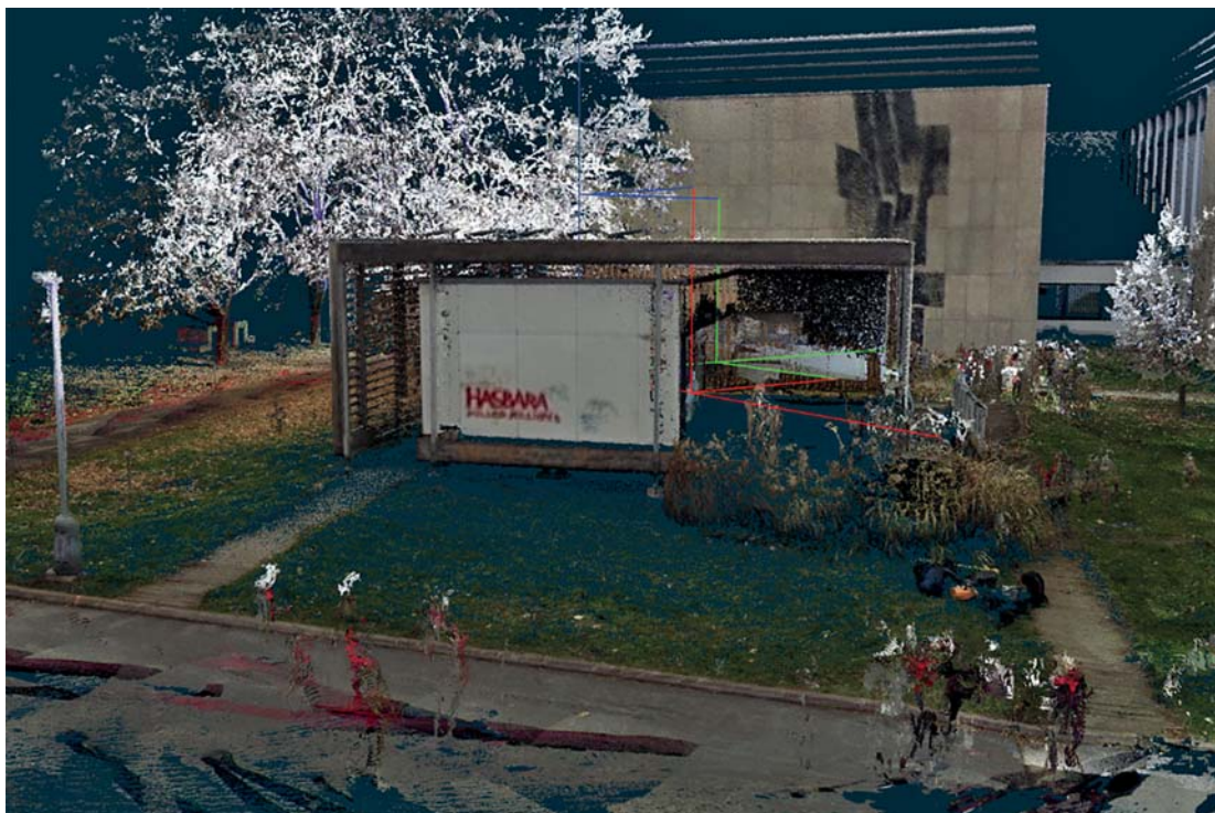
Obr. 9 Měřická data z laserového skenování FARO Orbis (zdroj: samotné měření)
