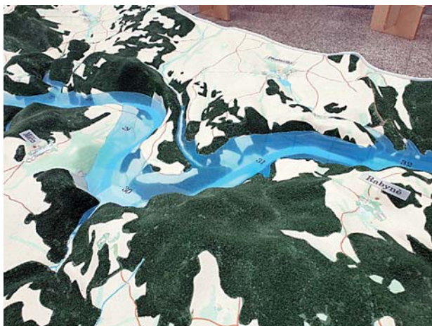
Obr. 17 Ukázka vytvořeného fyzického 3D modelu vodní nádrže Slapy
