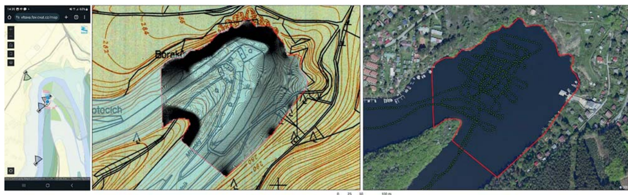
Obr. 10 Mobilní aplikace zobrazující krajinu před stavbou přehrady, body zájmu a aktuální polohu plavidla (vlevo); vrstevnice odvozené z batymetrického zaměření překrývajícího SMO-5 z roku 1950 a reálná data použitá pro odvození vrstevnic (vpravo)
