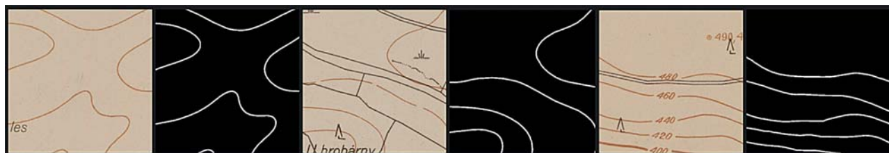
Obr. 6 Příklady trénovacích obrázků a jim odpovídajících binárních map
