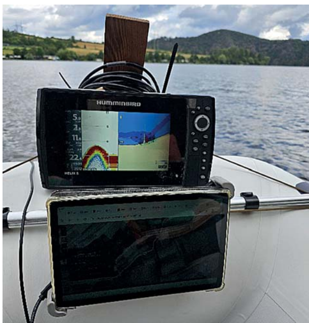
Obr. 2 Sonar umístěný na člunu spolu s tabletem pro zobrazení polohy člunu na archivním LMS
