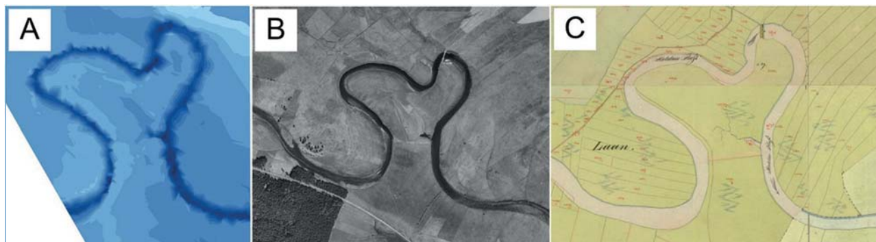
Obr. 12 Srdce řeky Vltavy; A – vizualizace naměřených batymetrických dat; B – ortofoto z počátku 50. let 20. století (zdroj: Ministerstvo obrany ČR); C – Císařský povinný otisk map stabilního katastru (zdroj: ÚAZK)
