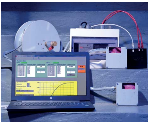
Obr. 18 Varianta mobilní soupravy hydrostatické nivelace
