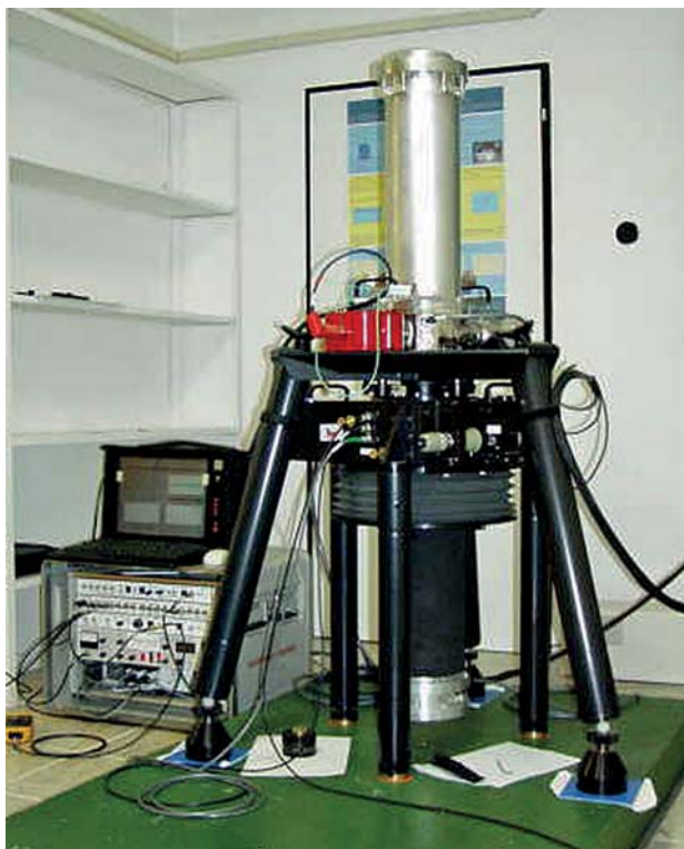
Obr. 10 Státní etalon tíhového zrychlení – Absolutní balistický gravimetr FG5 č. 215 na GO Pecný
