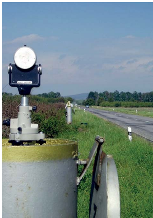
Obr. 9 Státní etalon délky 24 m až 1 450 m (Košnice)
