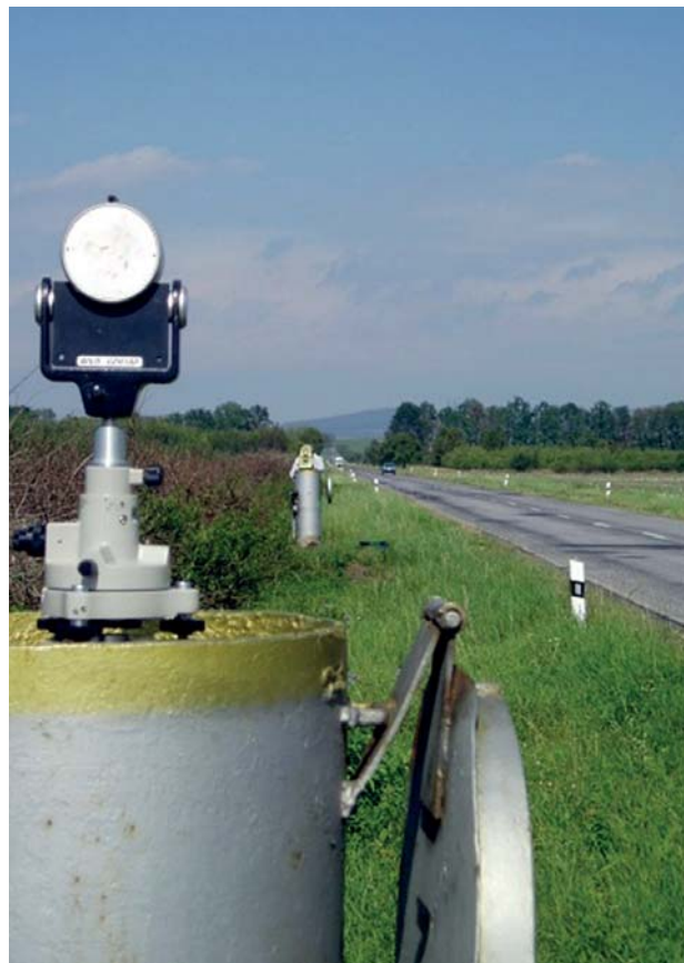
Obr. 9 Státní etalon délky 24 m až 1 450 m (Košnice)
