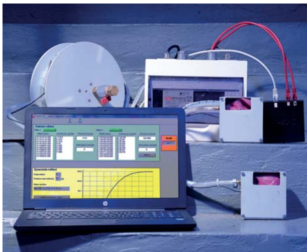
Obr. 18 Varianta mobilní soupravy hydrostatické nivelace
