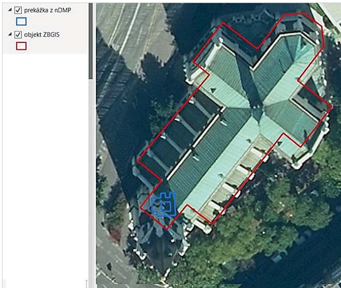
Obr. 10 Pridanie objektu ZBGIS ku prekážke určenej z nDMP
