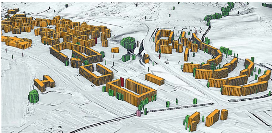
Obr. 29 3D zobrazenie prekážok vo forme polygónov nad DMR v ArcGIS Pro
