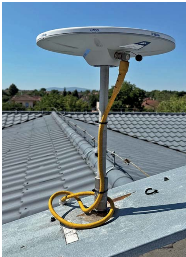
Obr. 1 Anténa referenčnej stanice SKSE v Senici
